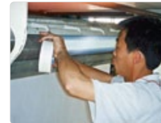
◀ Überlappende Ansatzverklebung in der Wellpappenherstellung, z.B. - tesa® 4962 - tesa® 4959
